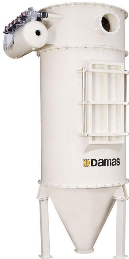
Die DSP-Schlauchfilter sind Unter- und Überdruckfilter, die für den Dauerbetrieb ausgelegt sind. Sie sind als selbsttragende Stahlkonstruktion ausgeführt. Das runde Design sorgt für hohe Festigkeit bei geringem Gewicht. Die Filter sind mit tangentialen 180°-Einlässen ausgestattet, um eine effektive Sortierung schwerer Materialien zu gewährleisten, bevor die Prozessluft durch den Filter strömt.
