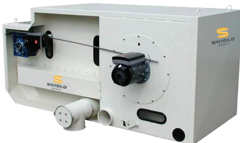
Der LOFCO ist ein moderner Hochleistungs-Aspirateur zur Abscheidung von leichten Partikeln aus Getreide, Saaten und anderen Granulaten.
