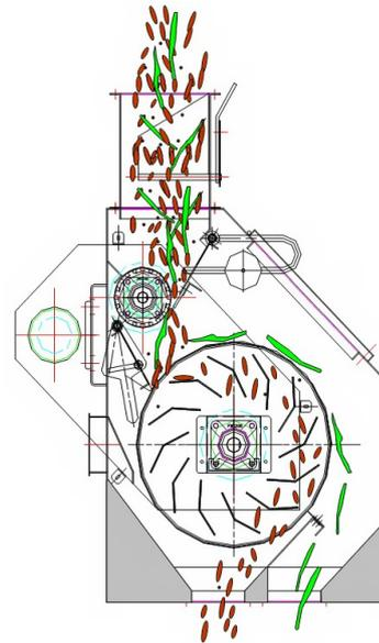
Die Rohware läuft über einen Verteiler und eine Speisewalze mit gewichtsbelastetem Leistungsschieber über die Strohtrommel hinein.
